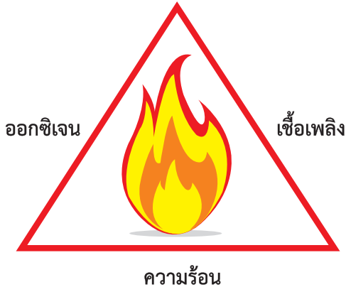
รูปที่ 6 สามเหลี่ยมของไฟ (Fire Triangle)
